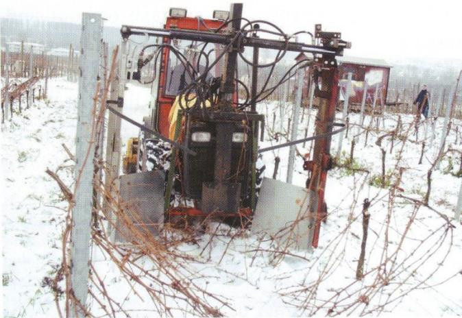
Abb. 4: Mit einem umgebauten, zweiseitigen Laubschneider werden die in die Gasse ragenden Triebteile abgeschnitten
