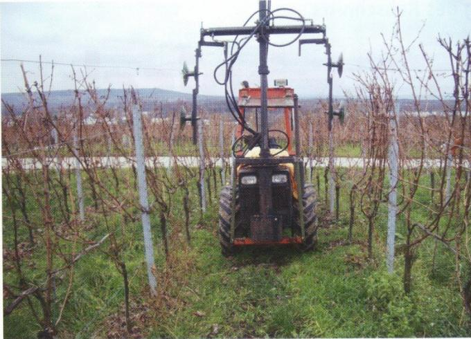
Abb. 2: Drahtablegerät für eine beidseitige Aufnahme von Heftdrähten
