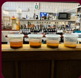
Nach dem Pressen setzen sich die Trubteile unten ab.
