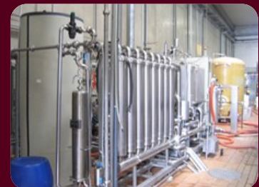
Moderne „Chros-Flowfilter“ haben eine hohe Filtrationsleistung.
