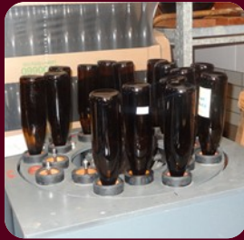
Vor der Füllung werden die Flaschen desinfiziert.
