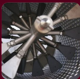
Die Flügel und der Korb drehen sich, sodass die Beeren durch die Löcher im Korb fallen.
