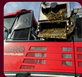
Traubenerntemaschine mit einer Entrappungsvorrichtung an Board.
