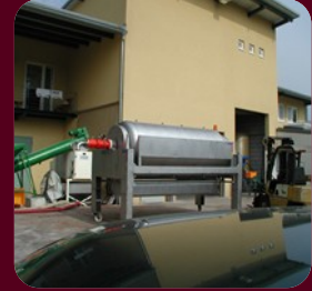
Membranpresse im Außenbereich
